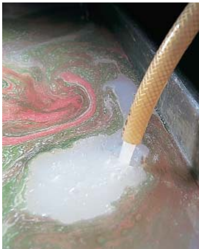
После очистки смазочно-охлаждающая жидкость возвращается в емкость.
