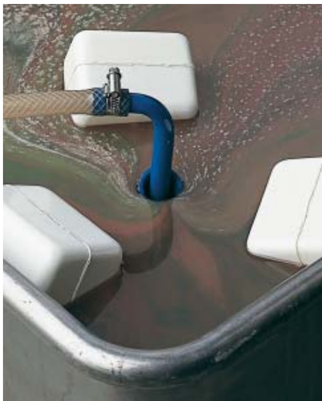
Подача загрязненной смазочно-охлаждающей жидкости с поверхностного слоя в емкость.
